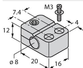
Befestigungsschelle für Gewinderohrsensoren, mit Festanschlag; Werkstoff: PA6
