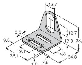
Befestigungswinkel für Gewinderohrsensoren; Werkstoff: Edelstahl A2 1.4301 (AISI 304)
