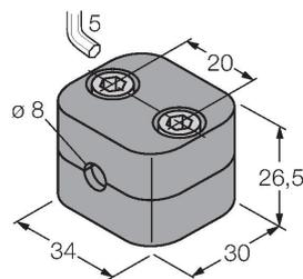
Befestigungsschelle für Glatt- und Gewinderohrsensoren; Werkstoff: Polypropylen
