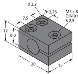
Befestigungsschelle für Gewinderohrsensoren; Werkstoff Montageblock: Aluminium, eloxiert
