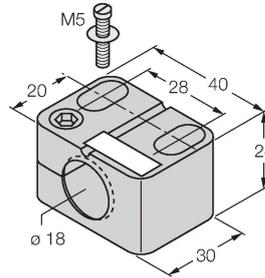
Befestigungsschelle für Gewinderohrsensoren, mit Festanschlag; Werkstoff: PA6
