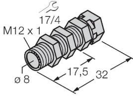
Schnellmontagehalterung mit Festanschlag; Werkstoff: Messing verchromt. Außengewinde M12 x 1. Hinweis: Der Schaltabstand der Näherungsschalter kann sich durch Verwendung von Schnellmontagehalterungen verringern.
