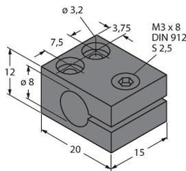
Befestigungsschelle für Gewinderohrsensoren; Werkstoff Montageblock: Aluminium, eloxiert
