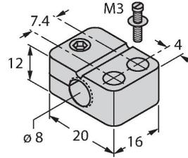
Befestigungsschelle für Gewinderohrsensoren, mit Festanschlag; Werkstoff: PA6
