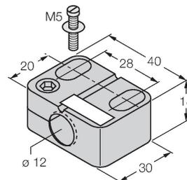
Befestigungsschelle für Gewinderohrsensoren, mit Festanschlag; Werkstoff: PA6
