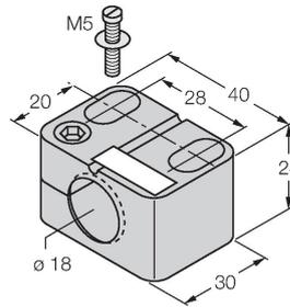
Befestigungsschelle für Gewinderohrsensoren, mit Festanschlag; Werkstoff: PA6
