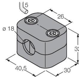
Befestigungsschelle für Glatt- und Gewinderohrsensoren; Werkstoff: Polypropylen
