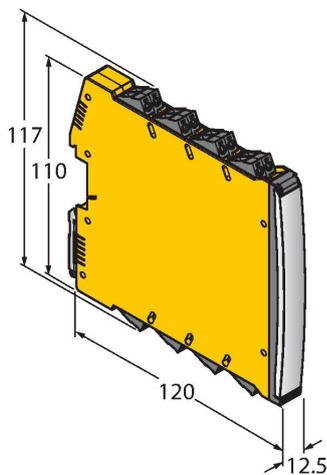
Trennschaltverstärker; zweikanalig; SIL2 gemäß IEC 61508; Ex-Ausführung; 2 Transistorausgänge; Eingang Namur Signal; abschaltbare Überwachung auf Drahtbruch und Kurzschluss; umschaltbar zwischen Arbeits- und Ruhestromverhalten; Signalverdopplung; abziehbare Schraubklemmen; 12,5 mm Breite; 24VDC Versorgungsspannung
