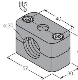
Befestigungsschelle für Glatt- und Gewinderohrsensoren; Werkstoff: Polypropylen
