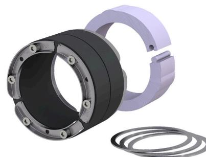
Zur Abdichtung von gewellten Kabelschutz- und Medienrohren. Die in das Wellenprofil eingelegten patentierten Clippinge verhindern Deformierungen und Beschädigungen des Wellrohres und sorgen gleichzeitig für einen homogenen Anpressdruck der Ringraumdichtung. Der mitgelieferte Isoring dient zur Zentrierung des Wellrohres auf der Gebäudeinnenseite und sorgt für einen sauberen Wandabschluss.
