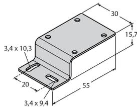
Montagewinkel, Edelstahl, horizontale Montage, für Bauform Q20
