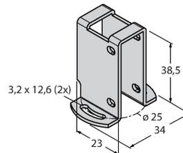
Schutzgehäuse, Edelstahl, für Bauform Q20
