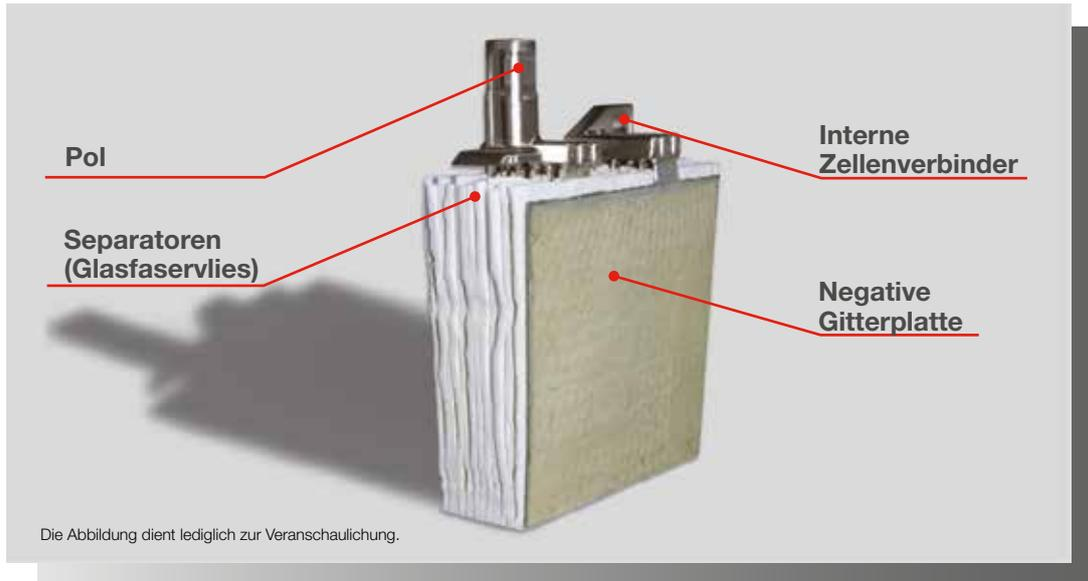
BEI DER BAUREIHE FLB WIRD DIE BEWERTE AGM-TECHNOLOGIE (ABSORBED GLASS MAT) EINGESETZT. DAS ELEKTROLYT IST VOLLSTÄNDIG IN MIKROPORÖSEN GLASFASER-SEPARATOREN GEBUNDEN MIT 99% INTERNER REKOMBINATION. DIE GEHÄUSE SIND ROBUST UND VERSCHLOSSEN. WÄHREND DER GESAMTEN GEBRAUCHSDAUER SIND DIE BATTERIEN VOLLSTÄNDIG WARTUNGSFREI. DIE GERINGE SELBSTENTLADUNG ERMÖGLICHT EINE LAGERFÄHIGKEIT VON 6 MONATEN.
