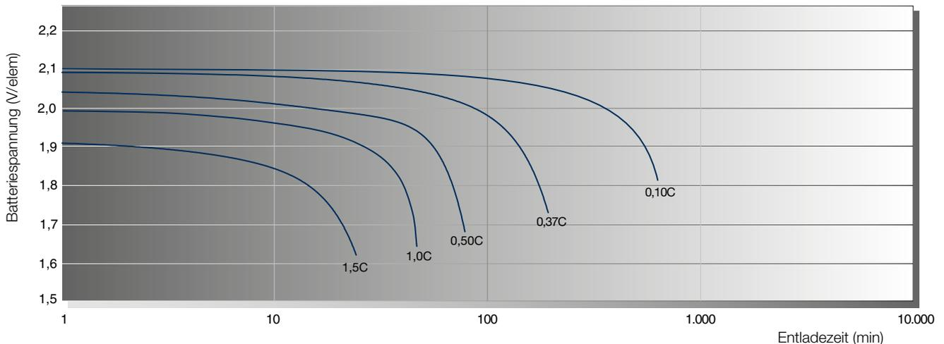
Die Abbildung zeigt typische Entladekurven. Genaue Werte sind den Produktdatenblättern zu entnehmen.
