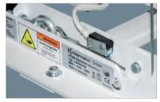
Als zusätzliches Sicherheitsfeature haben wir den Lift mit einer Schaltung ausgestattet, die den Lift beim Ausfahren auf ein Hindernis, sofort automatisch stoppt.
