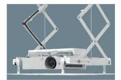
Besonders flach: Ist der Projektor nicht größer als 41 x 54 cm (BxL), kann er innerhalb der Montagebrücke installiert werden, so reichen 12 bzw. 14 cm Einbauraum in der Zwischendecke, bei einer Projektorhöhe von max. 6,5 cm.
