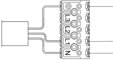
Durchgangsverdrahtung 5 polig
