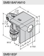
3012558 Montagewinkel, Werkstoff VA 1.4401, für 18mm-Gewinde, Gewinde M10 x 1,5
