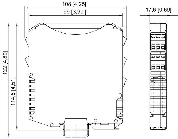
ISpac Reihen 9146, 9147, 9160, 9162, 9163, 9165, 9167, 9170, 9172, 9175, 9176, 9180, 9182, 9193, ISbus Reihe 9412 mit Schraubklemme
