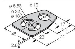
Montageplatte, Edelstahl, für Sensoren mit 18mm Gewinde
