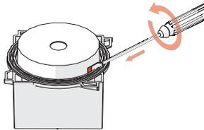
Schieben Sie einen Schraubendreher durch die Schlaufe und hebeln sie nach oben.
