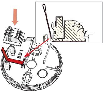
Fixieren Sie das Band durch Einsetzen des Klemmenblocks.
