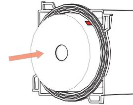
Schließen Sie die Leuchte. Achten Sie darauf, die Schlaufe des Bands nicht in der Dichtung des Deckels einzuklemmen.
