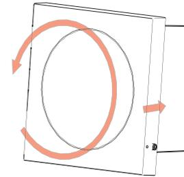
Setzen Sie den Deckel des IP65 Gehäuses auf und drehen es nach links.
