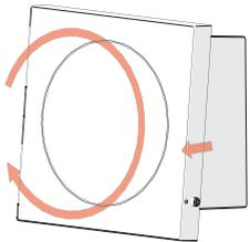
Drehen Sie den Deckel nach rechts und lösen ihn vom Gehäuse.
