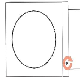
Verschrauben Sie das Gehäuse mit der Schraube.
