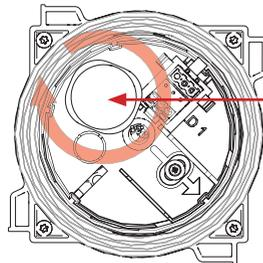
Setzen Sie die Bodenplatte der Leuchte in das Gehäuse, führen das Anschlusskabel durch und fixieren die Platine mit den beigelegten Schrauben und Unterlegscheiben.
