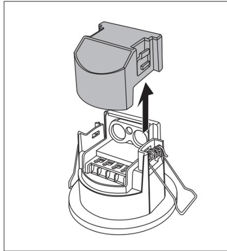
2. Entfernen Sie die Abdeckungen in der Anschlussabdeckung an den Stellen, an denen die Kabel durchgeführt werden sollen.
