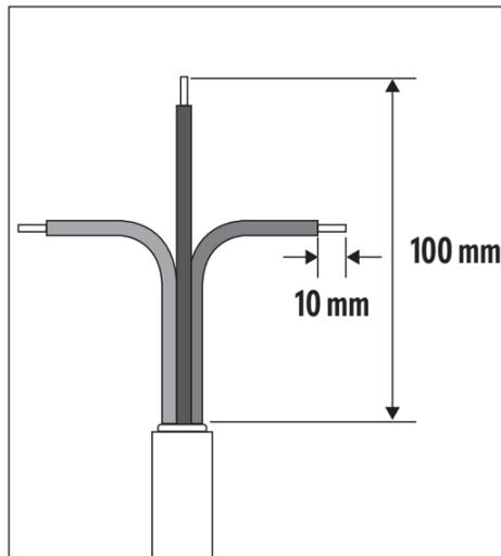
4. Schneiden Sie die Kabeleingänge an der Kabledichtung auf und führen Sie die Eingangs- und Ausgangskabel ein. Schließen Sie die 2-polige Klemme\* an, um die Erdleiter der Eingangs- und Ausgangskabel zu verbinden.
