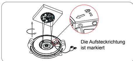
5. Schließen Sie die DALI-Busspannung an den DALI-Kabel der Leuchte an. Setzen Sie die Leuchte mittig auf die Montageplatte und drehen Sie anschließend die Leuchte im Uhrzeigersinn bis die Montageplatte komplett eingerastet ist.
