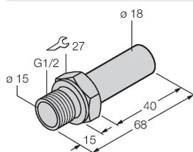
Übergangsadapter auf G1/2-Gewinde aus Edelstahl A4 (1.4571 / AISI 316Ti)
