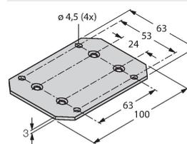
Montageplatte für Durchflussmesser FTCI zur frontseitigen Montage
