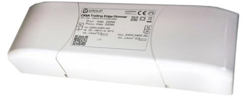
Der CASA Trailing Edge Dimmer ist ein Phasenabschnittsdimmer. Sein Einsatz ermöglicht stufenloses Dimmen von Phasenabschnittsleuchtmitteln. Ausgangsleistung 150W LED / 200W ohmisch (z.B Glühbirnen). Gesteuert wird er drahtlos mit der CASAMBI® App. Zugentlastung und Klemmenabdeckung sind integriert.
