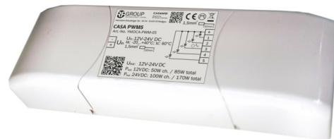
Die CASA PWM5 Einheit ermöglicht den direkten Zugriff auf vorkonfigurierte Funktionen der CASAMBI® Lichtsteuerung. Diese sind zum einen das Dimmen, An-/ und Ausschalten von Leuchten und zum anderen das Einstellen von Farben. Durch die Integration des fünften Kanals ist jetzt RGB CCT möglich. 5 Kanäle, Ausgangsspannung 12-24V DC. Ausgangsleistung maximal 100W (24V) pro Kanal, dabei insgesamt 170 W (24V) alle 5 Kanäle. Zugenutzte Leistung und Klemmenabdeckung sind integriert.
