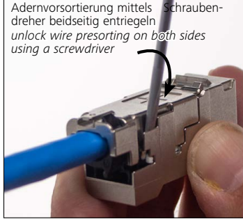
Beide Gehäuseteile voneinander trennen separate housing parts
