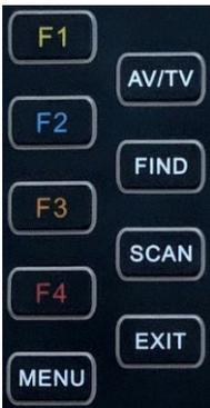
Die **Funktionstasten (F1-F4)** haben je nach Menüpunkt unterschiedliche Funktionen. Darauf wird zum späteren Zeitpunkt in der Bedienungsanleitung entsprechend eingegangen.
