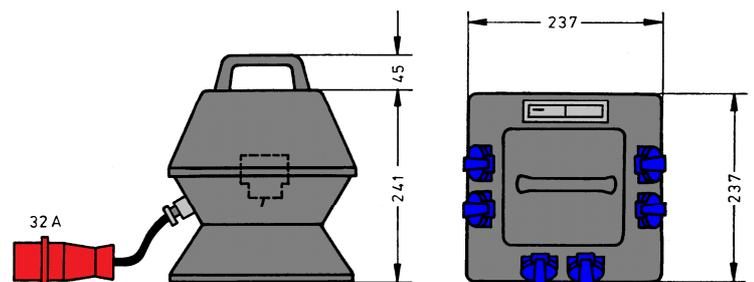
**ELEKTRA** – Steckdosenverteiler im Vollgummigehäuse mit Tragegriff,
