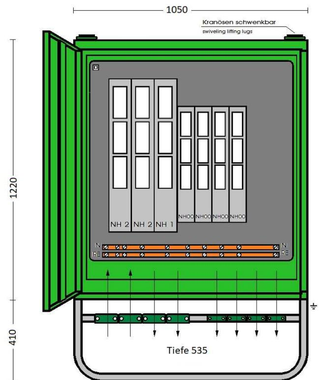
**ELEKTRA** - Gruppenverteilerschrank im Gehäuse aus verzinktem Stahlblech, pulverbeschichtet RAL 6018, bestückt mit:
