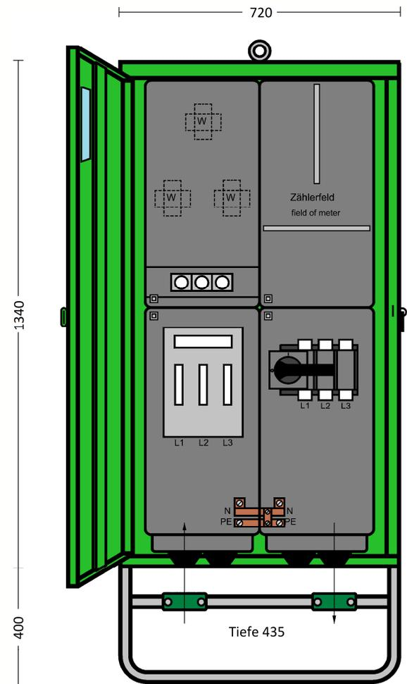
**ELEKTRA** - Anschlusschrank im Gehäuse aus verzinktem Stahlblech, pulverbeschichtet RAL 6018, bestückt mit:
