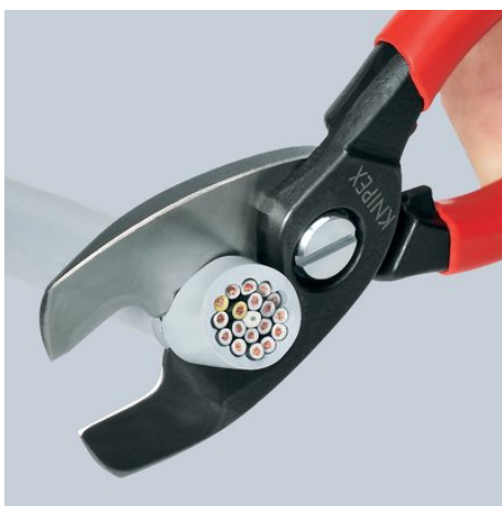
Nachschnitt: Nachdem der Mantel des Kabels im vorderen Profil durchgeschnitten wurde, werden die Leiter im hinteren Profil durchtrennt. Vorschnitt vorn, Nachschnitt hinten - so schneidet es sich leichter.
