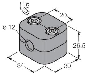
Befestigungsschelle für Glatt- und Gewinderohrsensoren; Werkstoff: Polypropylen
