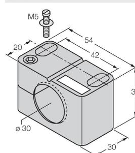
Befestigungsschelle für Gewinderohrsensoren, mit Festanschlag; Werkstoff: PA6
