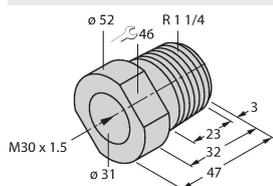
Montageadapter; Werkstoff: Polypropylen; Sensorwechsel bei gefüllten Behälter möglich (Adapter verbleibt beim Sensortausch im Behälter)
