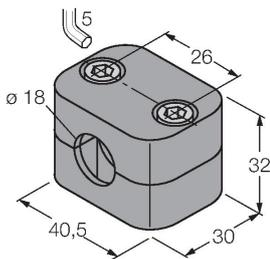
Befestigungsschelle für Glatt- und Gewinderohrsensoren; Werkstoff: Polypropylen
