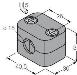
Befestigungsschelle für Glatt- und Gewinderohrsensoren; Werkstoff: Polypropylen
