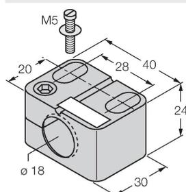
Befestigungsschelle für Gewinderohrsensoren, mit Festanschlag; Werkstoff: PA6
