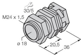
Schnellmontagehalterung mit Festanschlag; Werkstoff: Messing verchromt. Außengewinde M24 x 1,5. Hinweis: Der Schaltabstand der Näherungsschalter kann sich durch Verwendung von Schnellmontagehaltern ändern.
