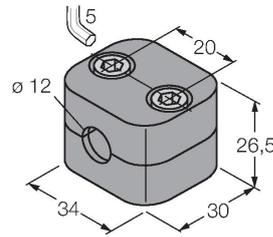
Befestigungsschelle für Glatt- und Gewinderohrsensoren; Werkstoff: Polypropylen
