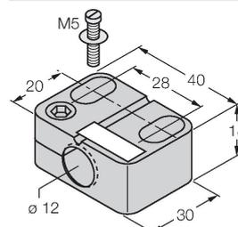
Befestigungsschelle für Gewinderohrsensoren, mit Festanschlag; Werkstoff: PA6
