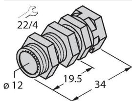
Schnellmontagehalterung mit Festanschlag; Werkstoff: Messing verchromt. Außengewinde M16 x 1. Hinweis: Der Schaltabstand der Näherungsschalter kann sich durch Verwendung von Schnellmontagehaltern ändern
