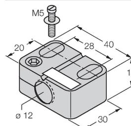
Befestigungsschelle für Gewinderohrsensoren, mit Festanschlag; Werkstoff: PA6
