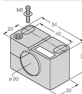
Befestigungsschelle für Gewinderohrsensoren, mit Festanschlag; Werkstoff: PA6
