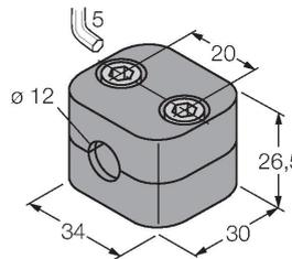
Befestigungsschelle für Glatt- und Gewinderohrsensoren; Werkstoff: Polypropylen
