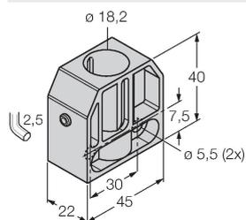
Befestigungsschelle für Gewinderohrsensoren; Werkstoff: PA66-GF
