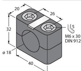
Befestigungsschelle für Gewinderohrsensoren; Werkstoff: PA66-GF
