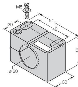
Befestigungsschelle für Gewinderohrsensoren, mit Festanschlag; Werkstoff: PA6
