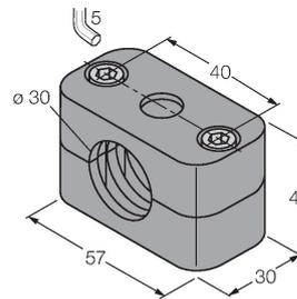
Befestigungsschelle für Glatt- und Gewinderohrsensoren; Werkstoff: Polypropylen
