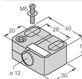
Befestigungsschelle für Gewinderohrsensoren, mit Festanschlag; Werkstoff: PA6
