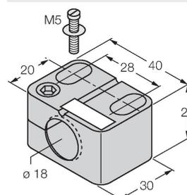
Befestigungsschelle für Gewinderohrsensoren, mit Festanschlag; Werkstoff: PA6
