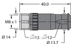
Konfektionierbare Kupplung, M8 x 1, gerade, 3-polig, Schraubklemmanschluss, Leitungsdurchlass 4.0 bis 5.5 mm, Adernquerschnitt/ Klemmvermögen 0.14 bis 0.5 mm<sup>2</sup>, Kunststoffgehäuse, Metallüberwurfmutter
