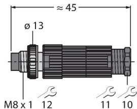
Konfektionierbarer Stecker, M8 x 1, gerade, 3-polig, Eindringtechnik, Leitungsdurchlass 4.0 bis 5.0 mm, Adernquerschnitt/ Klemmvermögen 0.14 bis 0.34 mm<sup>2</sup>, Kunststoffgehäuse, Metallüberwurfmutter
