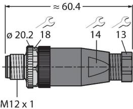
Konfektionierbarer Stecker, M12 x 1, gerade, 4-polig, Schraubklemmanschluss, Leitungsdurchlass 4.0 bis 6.0 mm, Adernquerschnitt/Klemmvermögen 0.14 bis 0.75 mm<sup>2</sup>, Kunststoffgehäuse, Metallüberwurfschraube
