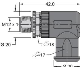
Konfektionierbarer Stecker, M12 x 1, gewinkelt, 4-polig, Schraubklemmanschluss, Leitungsdurchlass 4.0 bis 8.0 mm, Adernquerschnitt/Klemmvermögen 0.25 bis 1.5 mm<sup>2</sup>, Kunststoffgehäuse, Metallüberwurfschraube
