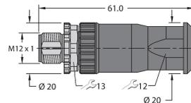
Konfektionierbarer Stecker, M12 x 1, gerade, 4-polig, Schraubklemmanschluss, Leitungsdurchlass 4.0 bis 8.0 mm, Adernquerschnitt/Klemmvermögen 0.25 bis 1.5 mm<sup>2</sup>, Kunststoffgehäuse, Metallüberwurfschraube
