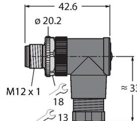
Konfektionierbarer Stecker, M12 x 1, gewinkelt, 4-polig, Schraubklemmanschluss, Leitungsdurchlass 4.0 bis 6.0 mm, Adernquerschnitt/Klemmvermögen 0.14 bis 0.75 mm<sup>2</sup>, Kunststoffgehäuse, Metallüberwurfschraube
