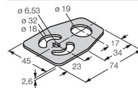
Montageplatte, Edelstahl, für Sensoren mit 18mm Gewinde
