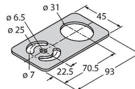
Montageplatte, Edelstahl, für Sensoren mit 30 mm Gewinde
