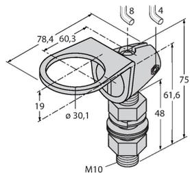
Montagewinkel, Edelstahl, für 30mm-Gewinde, Gewinde M10 x 1,5
