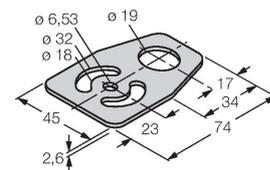
Montageplatte, Edelstahl, für Sensoren mit 18mm Gewinde
