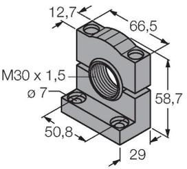
Montagehalterung, PBT-schwarz, für Sensoren mit 30-mm-Gewinde, ausrichtbar
