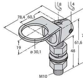
Montagewinkel, Edelstahl, für 30mm-Gewinde, Gewinde M10 x 1,5
