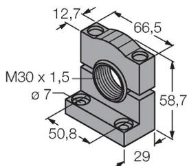
Montagehalterung, PBT-schwarz, für Sensoren mit 30-mm-Gewinde, ausrichtbar
