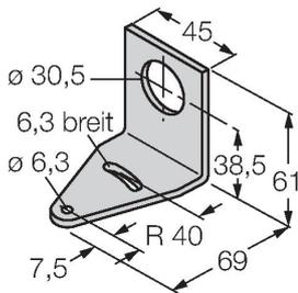
Montagewinkel, rechtwinklig, Edelstahl, für Sensoren mit 30mm Gewinde
