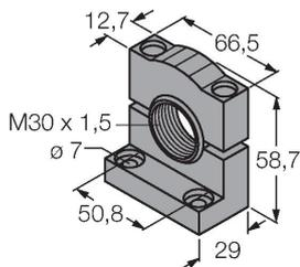
Montagehalterung, PBT-schwarz, für Sensoren mit 30-mm-Gewinde, ausrichtbar
